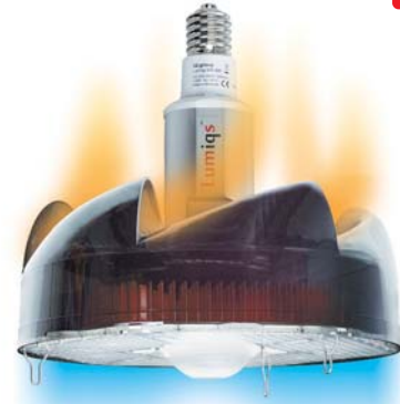
放熱板で温められた空気は、本体下部の隙間から外部の冷たい空気を引き入れながら、本体カバーの排気口から排出されます。
