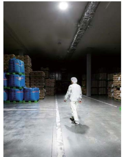
センサーが人を検知すると、自動的に照明が点灯します。
