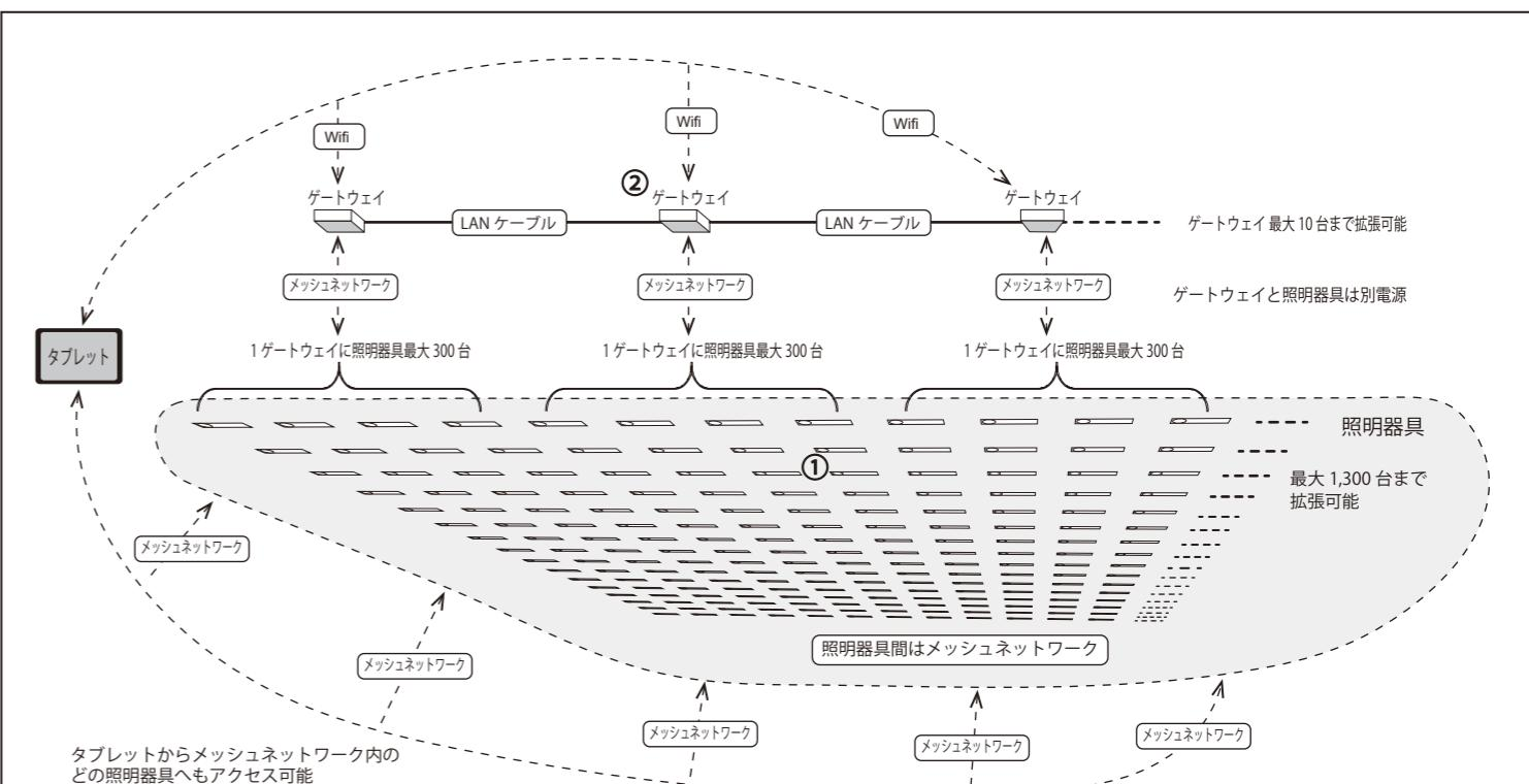
本システムは、照明をメッシュネットワークでつなぎ、照明のグループ化や明るさ等を、タブレットで直感的に設定できる省エネ照明システムです。データ送受信用のゲートウェイ1台で300台までの照明が制御でき、ゲートウェイを複数台設置すれば、1フロアで最大1300台まで制御できます。専用のセンサー付き照明器具と専用ゲートウェイ、Android搭載のタブレットが必要です。300台以上の照明を制御する場合は、ゲートウェイを複数台設置しLANケーブルで接続します。
